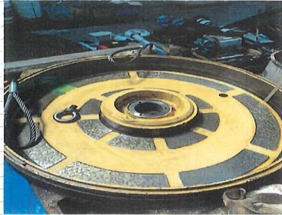
・摩耗部摺動面を作研磨加工、摺り合わせ修正実施
