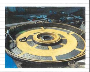
・摩耗部摺動面を作研磨加工、摺り合わせ修正実施
